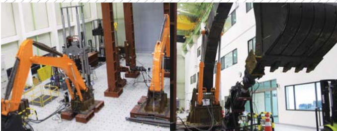
▲ 건설용 굴삭기 암의 정적 및 피로성능 평가 ▲ 장대 교량 및 건축구조물의 구조·피로실험
