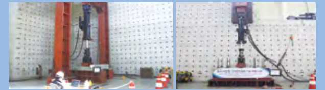
경험적설계법 적용을 위한 교량바닥판용 리브택의 편칭전단강도 실험
