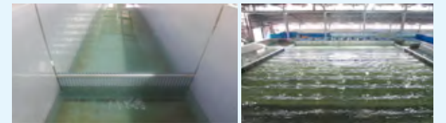
지진 및 폭풍해일 침수피해 방지시설 구조물 개선을 위한 단면수리실험
